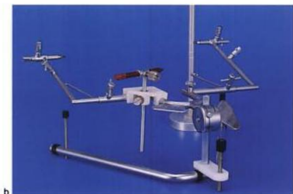
Fig. 19 Montaje de la punta gráfica y la punta espinal a la altura del eje del articulador con ayuda de una regla metálica. Las puntas se ajustan a la altura de la muesca superior, que se corresponde con la altura del eje del articulador del modelo Condylator 6. Las tres muescas se corresponden además con las distintas alturas de los ejes en diversos modelos Condylator.
