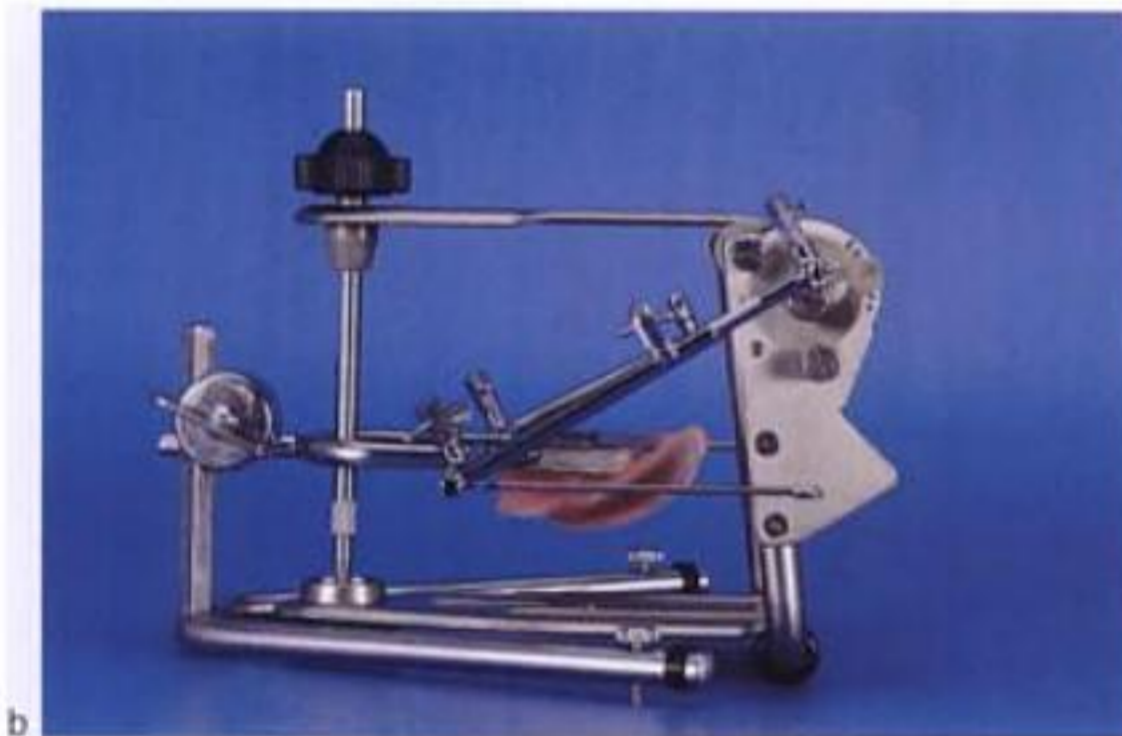
Fig. 53 Cuando las puntas gráficas se sitúan a alturas distintas quedará una más alta y otra más baja que el eje del articulador. De esta forma se puede mantener el plano oclusal horizontal. a) Imagen frontal. b) Lateral.
