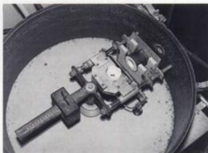
Fig. 12-20 Máquina de colado mediante fusión por inducción. A , Resorte de inducción enfriado con agua. B , Crisol vertical (área blanca) colocado dentro del resorte de inducción.
