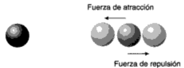
Fig. 2-6 Las fuerzas de atracción y repulsión se equilibran unas a otras y el átomo B alcanza su posición de equilibrio. (Por cortesía de K.J. Söderholm.)
