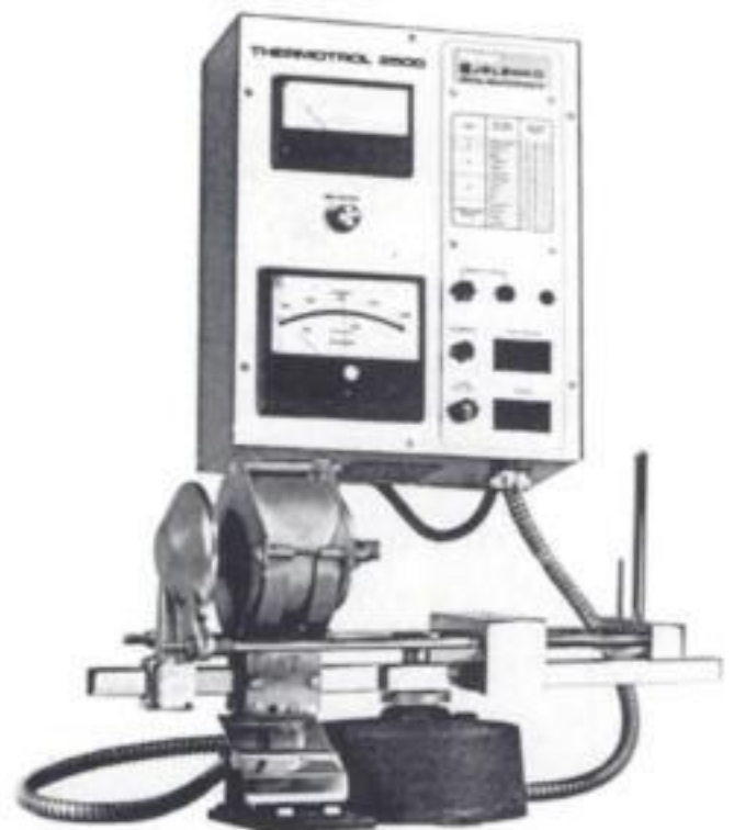
Fig. 12-19 Máquina para colado de giro de resorte para fundición que funciona con resistencia eléctrica.
