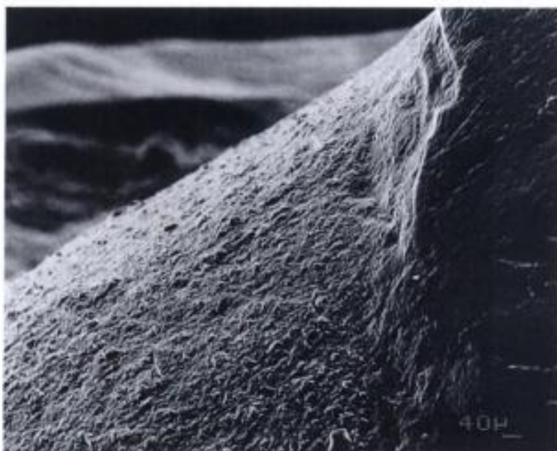
Fig. 15-8 Fotografía al microscopio electrónico de barrido de la superficie oclusal de una restauración de resina compuesta tradicional en la zona posterior que ha sido colocada hace 5 años. La resina compuesta se ha eliminado en el margen oclusal de la derecha, y se han expuesto las partículas de relleno mayores, por lo que presenta una superficie rugosa. (Por cortesía de K.-J.M. Söderholm.)
