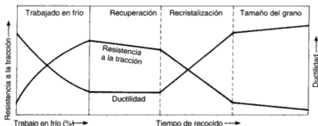
Fig. 20-9 Resistencia a la tracción y ductilidad de un metal en función del porcentaje de trabajado en frío y el tiempo de recocido. Durante el tratamiento en frío, la resistencia a la tracción aumenta y la ductilidad disminuye. Estas propiedades cambian ligeramente con la recuperación. Durante la recristalización, la resistencia a la tracción disminuye y la ductilidad se incrementa rápidamente. Sólo se producen pequeños cambios durante el crecimiento del grano. (De Richman MH: Introduction to the Science of Metals . Waltham, MA, Blaisdell Publishing Co, 1967.)
