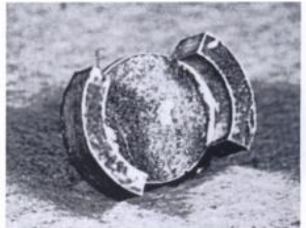
Fig. 12-28 Colado de una aleación de metal noble recubierto de negro debido a la contaminación con azufre o a la oxidación durante la fusión de la aleación.
