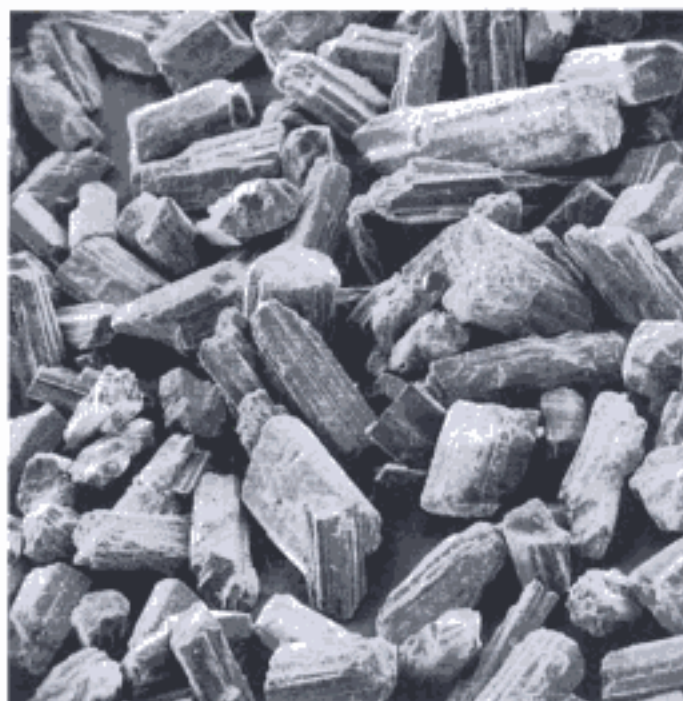
Fig. 10-2 Partículas de polvo del yeso piedra (hemihidrato \alpha ). Los cristales son prismáticos y tienen una forma más regular que los del yeso dental. Se han retirado las partículas muy finas que forman parte habitual de su composición, como se hizo con las partículas del yeso de la figura 10-1. (x400.) (Por cortesía de B. Giannara y R. Neiman.)
