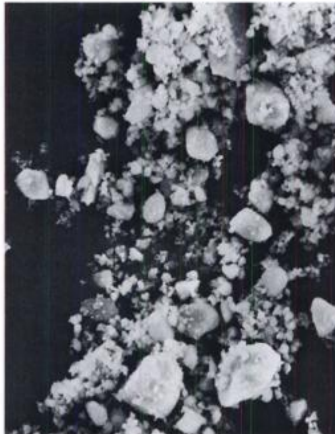
Fig. 15-9 Partículas típicas de resinas compuestas de partícula pequeña. (Por cortesía de E. A. Glasspoole y R. Erickson.)
