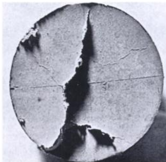
Fig. 12-17 Crestas o rebabas de la superficie de un colado que se forman como resultado de fracturas en el revestimiento antes de colar el metal.
