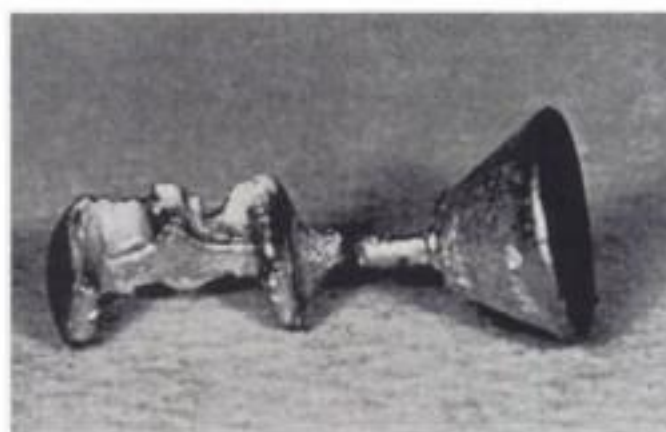
Fig. 12-13 Contracción localizada producida por utilizar un bebedero con un diámetro inadecuado.
