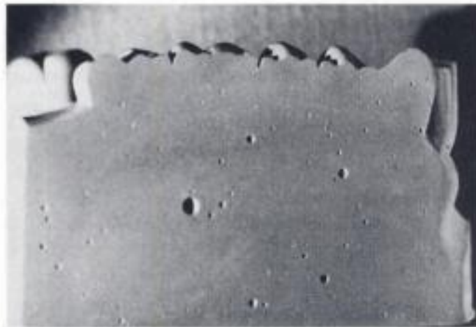
Fig. 10-10 Sección de un modelo de yeso piedra fraguado que no fue mezclado adecuadamente. Las burbujas de aire debilitan la escayola y deterioran su aspecto.
