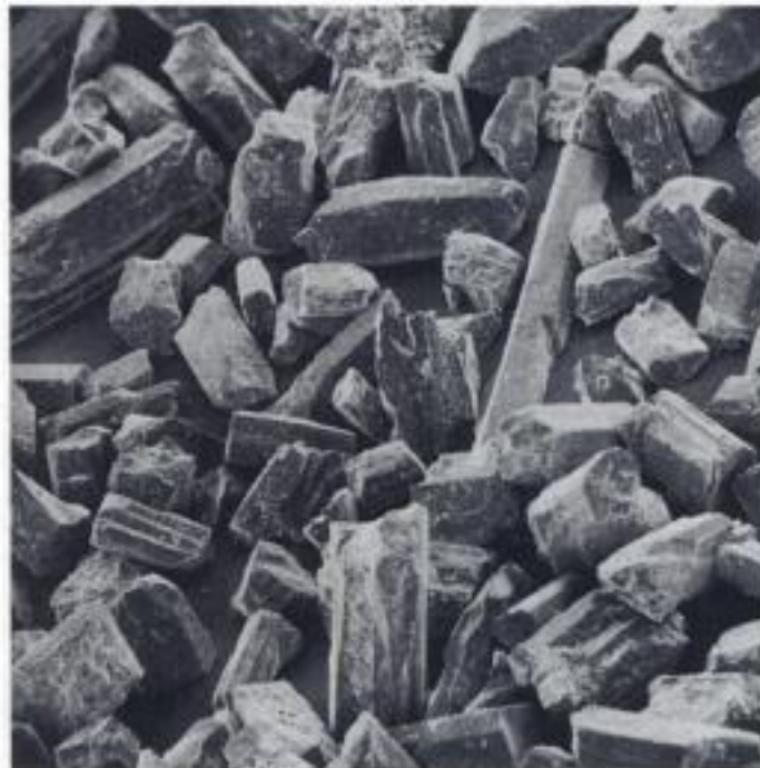
Fig. 10-9 Partículas de polvo de los yesos piedra tipo IV y V. ( \times 400 .) (Por cortesía de B. Giammara y R. Neiman.)
