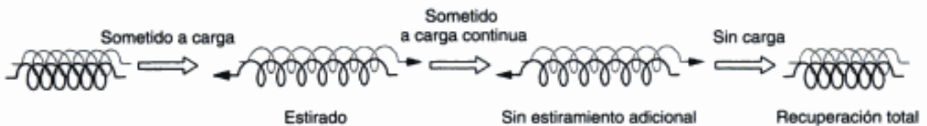
Fig. 7-5 Recuperación elástica: comportamiento similar a un resorte (rápido y reversible). Las cadenas se estiran, pero no se superponen entre ellas debido a las zonas cristalinas y a los entrecruzamientos. Por tanto, al eliminar la carga vuelven a adquirir completamente la forma espiral.
