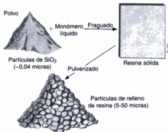
Fig. 15-12 Preparación de las partículas de relleno que se emplean en las resinas compuestas de microrrelleno. Las partículas de relleno de una resina compuesta de microrrelleno constan de «partículas de relleno de resina» pulverizadas que están dispersas en una matriz fraguada de resina. Las partículas de sílice coloidal pirogénico (~0,04 \mu\text{m} ) se incorporan tanto a las partículas de relleno de la resina prefraguada como al monómero, aunque la resina prefraguada contiene mucha mayor concentración. (Modificada de P. Lambrechts: Basic Properties of Dental Composites and Their Impact on Clinical Performance . Tesis. Katholieke University, Leuven, Bélgica, 1983.)
