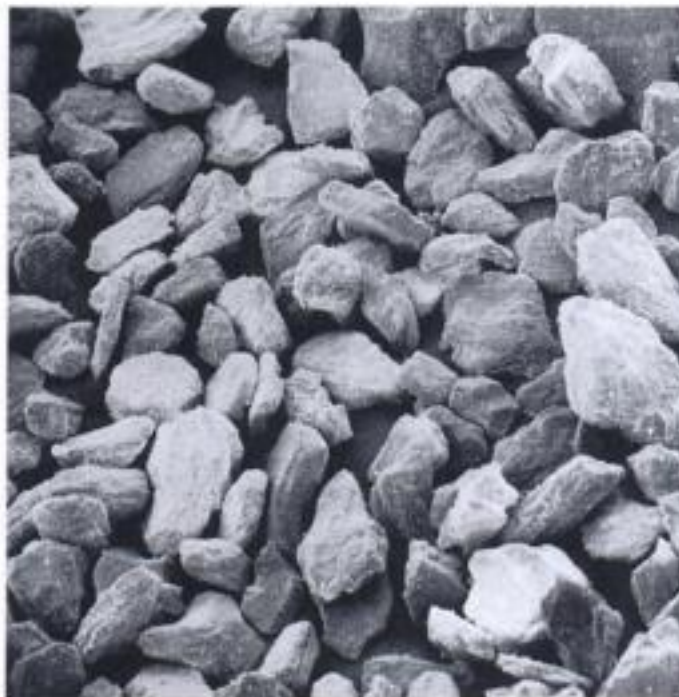
Fig. 10-1 Partículas de polvo del yeso de París (hemihidrato \beta ). Los cristales tienen una forma esponjosa e irregular. ( \times 400 .) (Por cortesía de B. Giannara y R. Neiman.)
