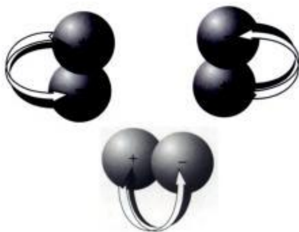
Fig. 2-5 Dipolo que fluctúa y une las moléculas de gas inerte. Las flechas muestran cómo pueden fluctuar los campos de manera que las cargas son alternativamente positivas y negativas. (Por cortesía de K.J. Söderholm.)
