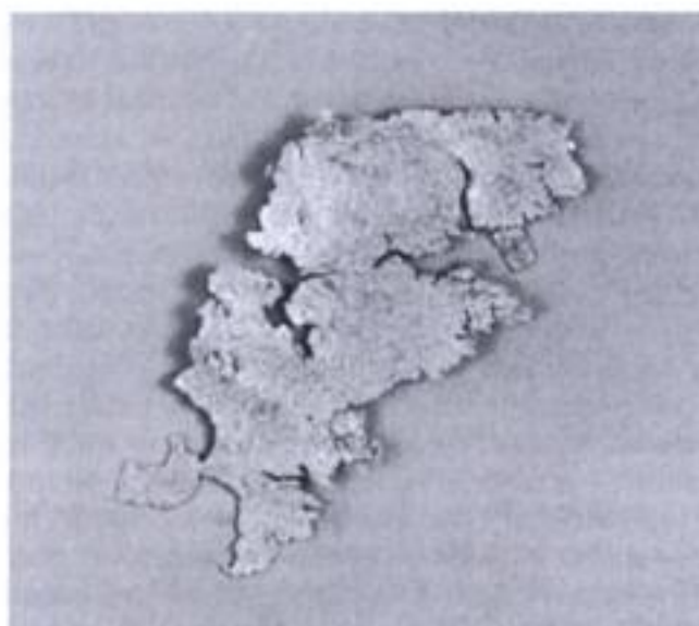
Fig. 17-21 Mezcla de amalgama infratriturada. Este tipo de mezcla tiene escasa dureza y poca resistencia a la corrosión.
