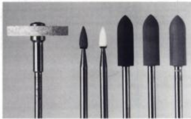
Fig. 13-6 Los instrumentos abrasivos aglutinados característicos empleados en el laboratorio dental incluyen ruedas y puntas con aglutinante vítreo (los tres instrumentos de la izquierda) y puntas abrasivas en forma de bala aglutinadas con goma (los tres instrumentos de la derecha).
