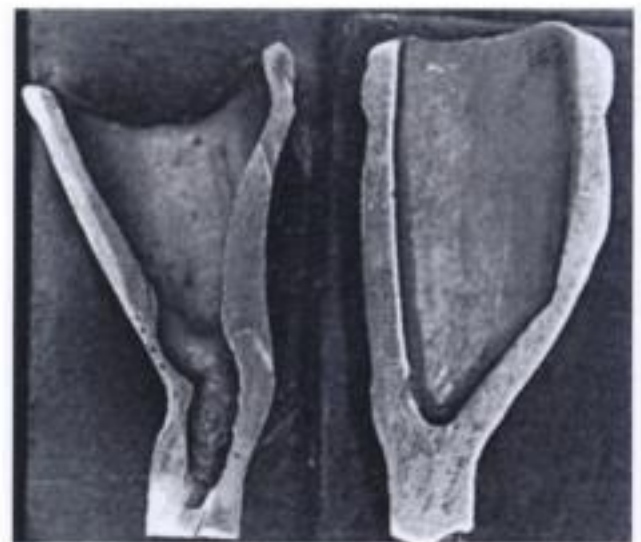
Fig. 12-25 A, Microporosidad, porosidad del tamaño de la punta de un alfiler e inclusiones de gas. Los vacíos de la microporosidad tienen una forma irregular, mientras que los otros dos tipos tienden a ser esféricos; los espacios esféricos más grandes son inclusiones de gas. B, Porosidad bajo la superficie. C, Porosidad de contracción localizada. (Por cortesía de G. Ryge.)
