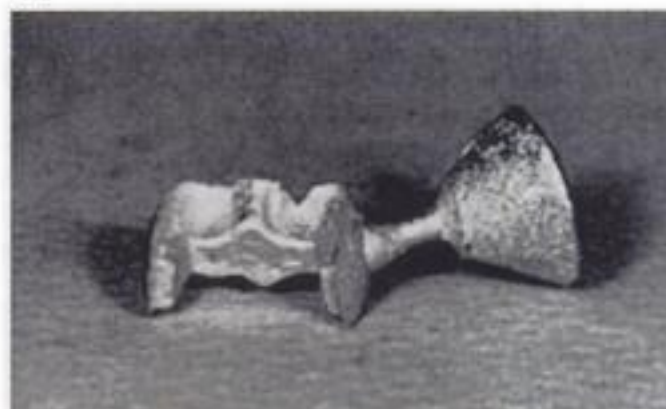
Fig. 12-14 A, El bebedero separado muestra una severa porosidad en el punto de unión debido a la turbulencia provocada por una angulación inadecuada del bebedero. B, Se obtiene un buen colado si se coloca el bebedero con una angulación de unos 45° con respecto a la pared proximal.
