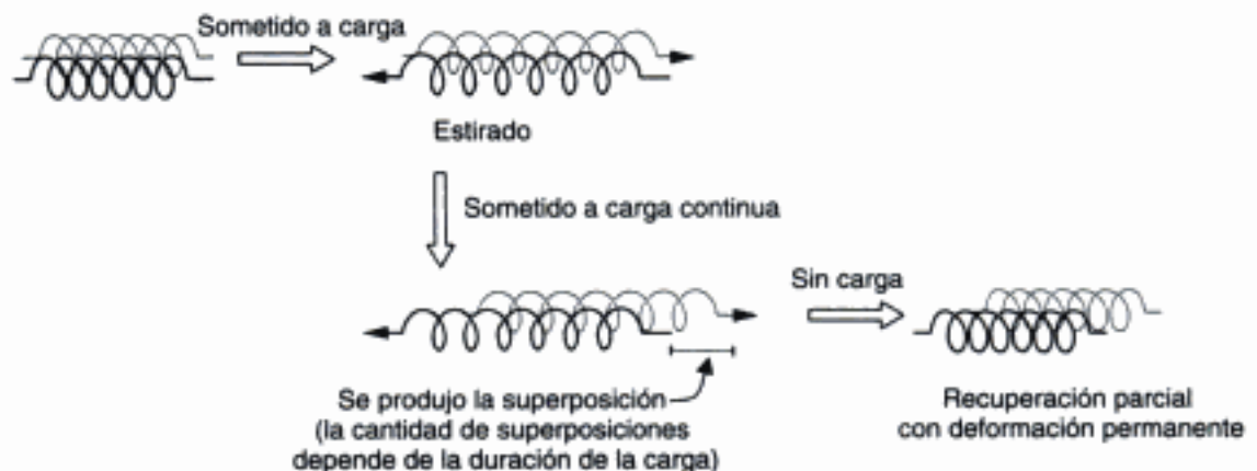
Fig. 7-6 Recuperación viscoelástica: las cadenas se estiran y se superponen entre ellas, produciendo una distorsión plástica, irreversible y permanente, así como la recuperación parcial al eliminar la carga.
