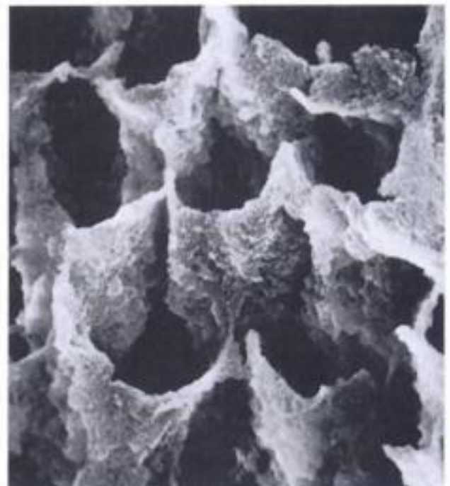
Fig. 14-3 Imagen de microscopio electrónico de barrido de las prolongaciones que se forman cuando la resina penetra dentro de las zonas grabadas del esmalte. La resina se aplicó al esmalte y después el esmalte grabado se disolvió mediante ácido para mostrar estas prolongaciones (magnificación original \times 5000 ). (Por cortesía de K.-J. Söderholm.)
