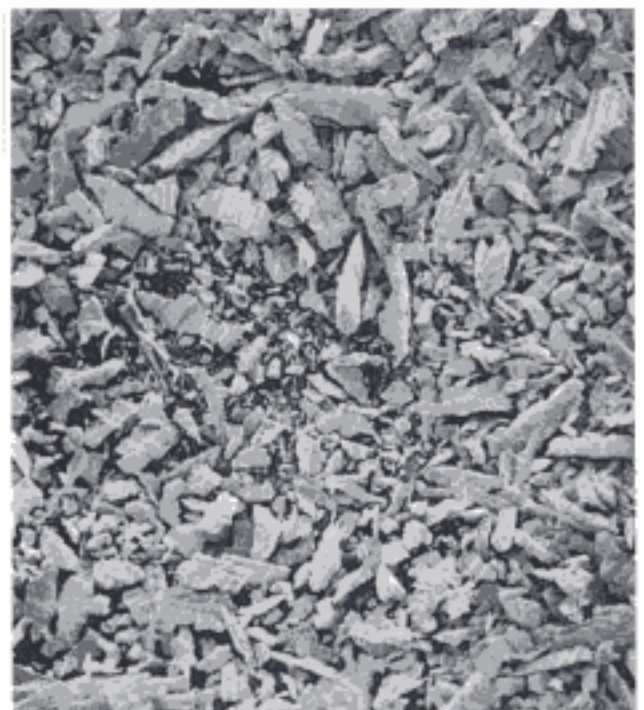
Fig. 17-1 Partículas de aleación de amalgama convencional cortada a torno. (x100.)
