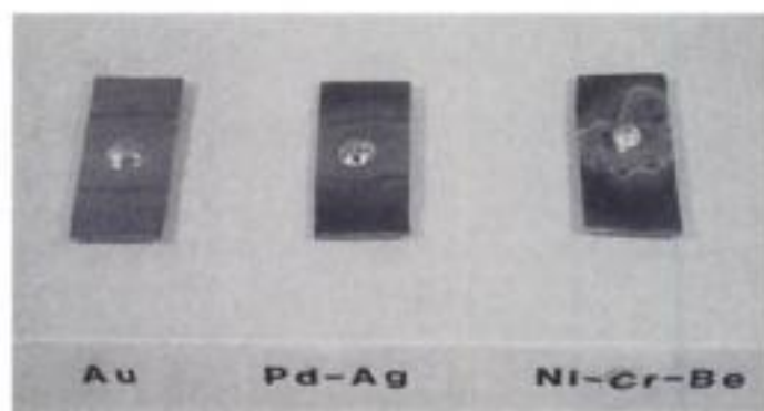
Fig. 19-6 Plata pura fundida en tres aleaciones diferentes. La plata moja la aleación de oro (Au) y la de plata-paladio (Pd-Ag), pero no fluye sobre la superficie de la aleación de metal base (Cr-Ni-Be). (Por cortesía de C.E. Ingersoll.)
