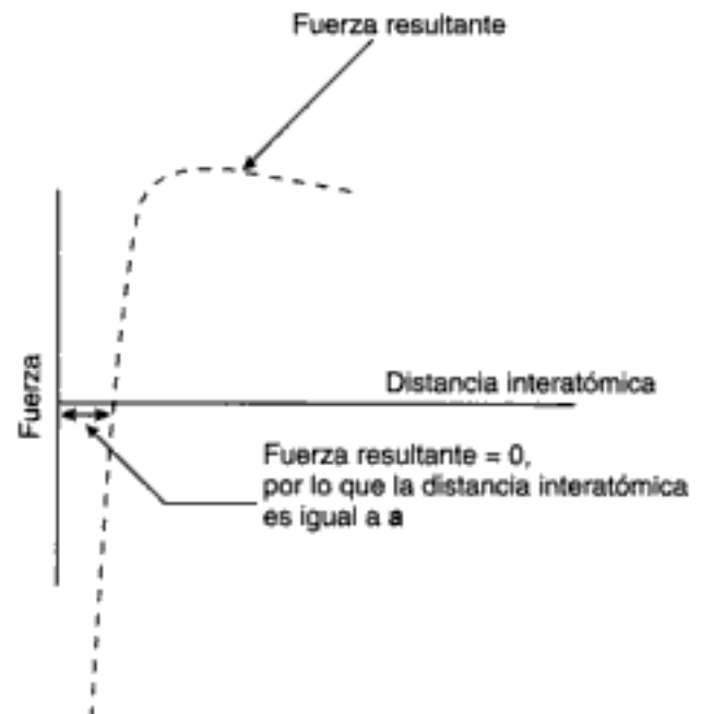
Fig. 2-7 Cuando se alcanza la posición de equilibrio, la distancia interatómica es a . Si el átomo se mueve de esta posición, se necesita una fuerza negativa (de repulsión) o positiva (de atracción) para hacer que el átomo vuelva a la posición de equilibrio indicada en la figura 2-6. (Por cortesía de K.J. Söderholm.)
