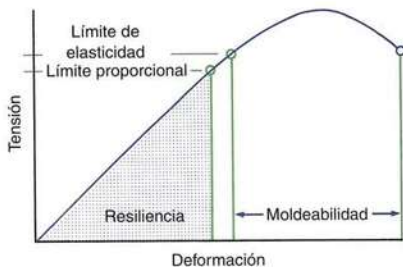
FIGURA 10-4 La resiliencia y la moldeabilidad se definen como una superficie bajo la curva de tensión-deformación y una distancia a lo largo del eje de las X, respectivamente, como puede verse en este ejemplo. Dado que la deformación plástica que hace que un material sea moldeable se puede considerar también como una forja en frío, podemos tomar igualmente la moldeabilidad como la superficie que hay bajo esa parte de la curva de tensión-deformación.
