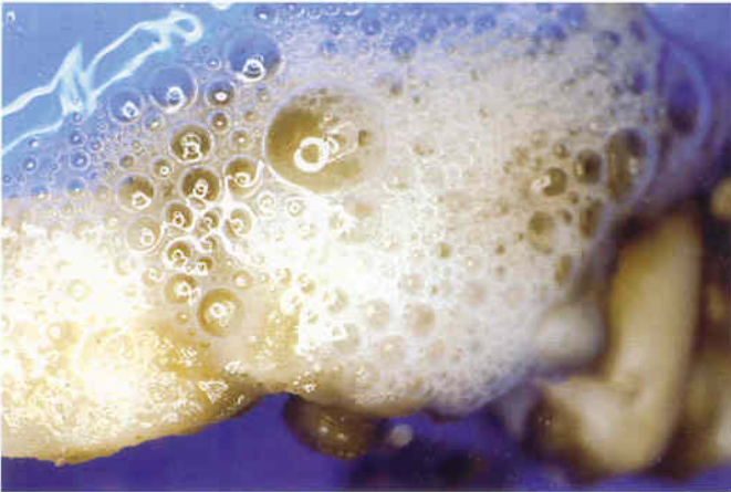
FIGURA 5.34. Lavado con una mezcla de agua destilada y carbonato de sodio con el fin de neutralizar el ácido.
