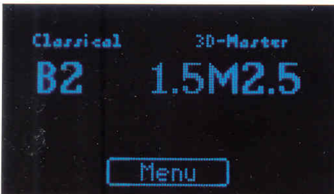
FIGURA 2.35. La pantalla muestra la medición del color en los sistemas Classical y 3D-Master. Medición estándar.
