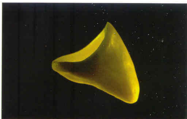
FIGURA 11.1a. Refuerzo de alto contenido de alúmina con infiltrado de vidrio (In-Ceram, Vita Alemania) que le da resistencia a la corona.
