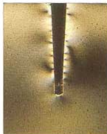
15.150 Los bordes dentados producen una mayor concentración de tensiones, pero menor que la de los postes roscados (cortesía del Sr. P. O'Neilly)
