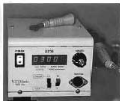
9.161 Motor Nitimatic con control de la velocidad/torque
