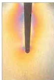
15.121 Los postes cónicos generan una fuerza en cuña durante la función (cortesía del Sr. P. O'Neilly)
