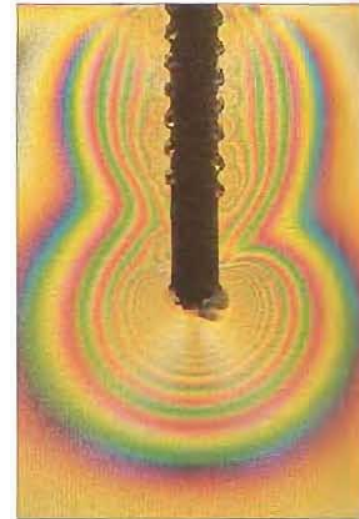
15.145 Las tensiones aumentan al apretar el poste un cuarto de vuelta (cortesía del Sr. P. O'Neilly)
