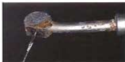
7.211 Corrosión por hipoclorito de sodio de pieza de mano endosónica
