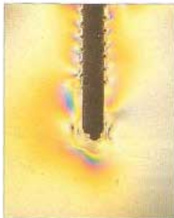
15.149 Al cargar el poste las tensiones disminuyen considerablemente en comparación con 15.146 (cortesía del Sr. P. O'Neilly)
