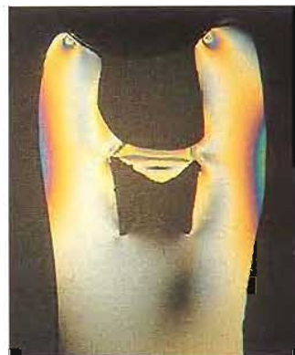
15.5, 15.6 En estos modelos fotoelásticos se puede apreciar que la concentración de tensiones es mayor en la base de las cúspides (flechas) cuando se suprime el techo de la cámara pulpar (cortesía del Sr. P. O'Neilly)
