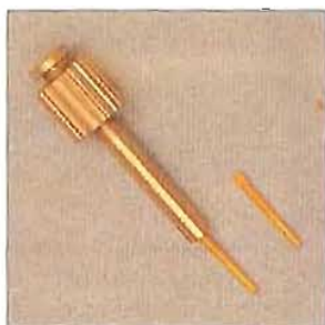
15.167 Llave de mano para la introducción de pins
