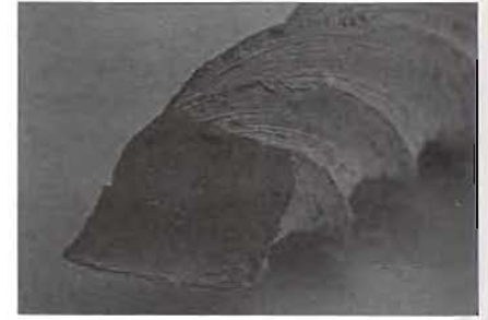
7.117 Imagen de MEE de una lima con la punta fracturada
