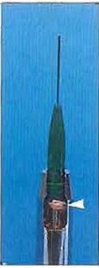
9.135 Fractura de la cánula debido a la prisa o a un calentamiento inadecuado
