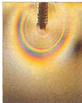
15.165 Los pins roscados son los que generan mayores tensiones (cortesía del Sr. P. O'Neill)
