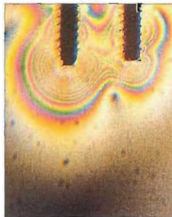
15.168 Los pins colocados muy juntos generan tensiones acumulativas (cortesía del Sr. P. O'Neill)
