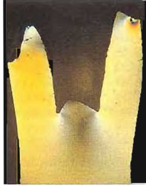
15.51 Demostración fotoelástica de la ausencia de concentración de tensiones cervicales como consecuencia de la restauración con un onlay colado de recubrimiento cuspeo (cortesía del Sr. P. O'Neilly)
