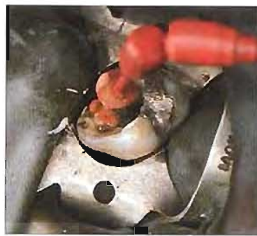
9.145 Colocación del obturador
